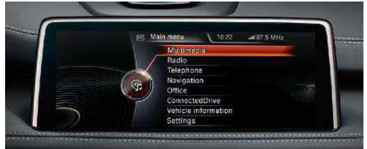
Sistema de navegación. Con representación de mapas en 3D, pantalla a color de 10.25", controlador iDrive Touch y disco duro de 20 GB para archivos de música. De serie.
