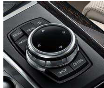
Controlador iDrive Touch. Cuenta con una superficie táctil en la parte superior que permite ingresar fácilmente direcciones o números en el sistema de navegación mediante el movimiento de la mano. De serie.
